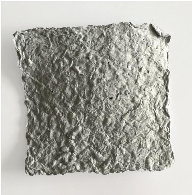
Cet échantillon de papier contient du graphite ( espèce minérale qui est, avec le diamant et le lonsdaléite, l'une des trois formes cristallisées naturelles du carbone). Malheureusement dû à sa faible dose de graphite je n'ai pas réussi à le rendre conducteur après le séchage. Il s'avère cependant être très conducteur lorsqu'il n'est pas encore sec, encore une fois grâce à l'eau.
